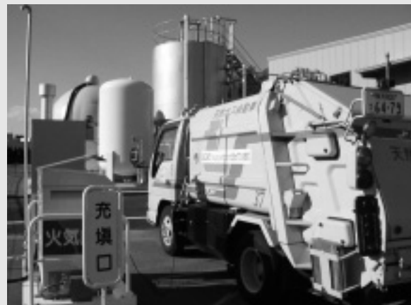
ごみ収集車へのバイオガスへの充填状況
