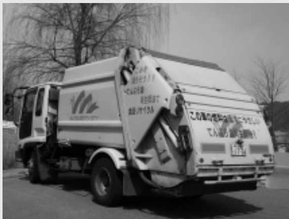
再生軽油で走行しているパッカー車
