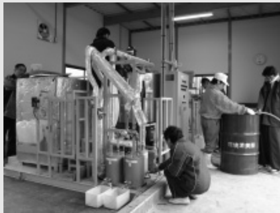
共立学舎の再生軽油精製装置
