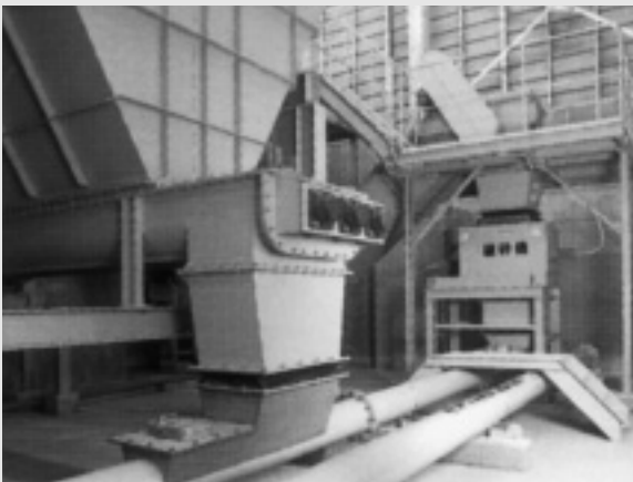
破碎機：生分解性プラスチックの袋を破り、生ゴミを破碎する
