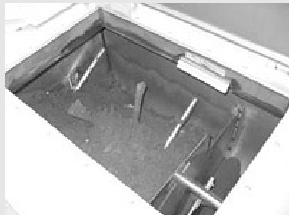
業務用生ごみ処理機（バイオ型）30kg日。生産農家ができた生成物を定期的にとりだす。
